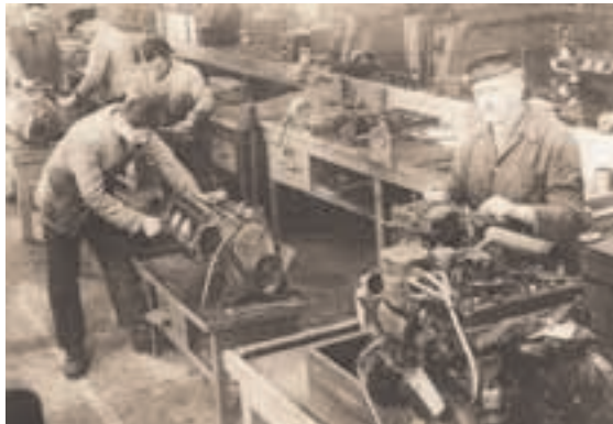
Die Montage der Motoren erfolgte in fließender Fertigung, die durch viele Kontrollen überwacht wurde.
